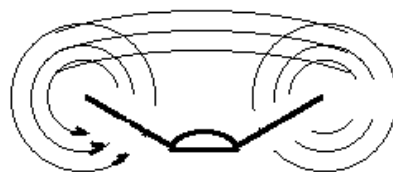
Ondas frontais cancelam as ondas da parte de trás
